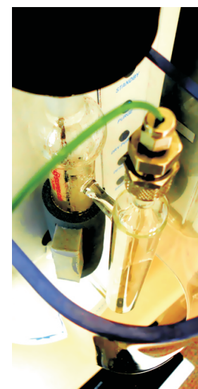
Рисунок 4. Разделение летучих органических соединений. Колонка: 054983 BPX-Volatiles 60м/0.32мм/1.8мкм. Темп.программа: 40 °С на 3мин., затем 10 °С/мин до 190 °С, затем 20 °С/мин 250 °С. Инжектирование: 0.5мкл в метаноле, д.п. 1:30 Результаты: компания "Хроматэк".
